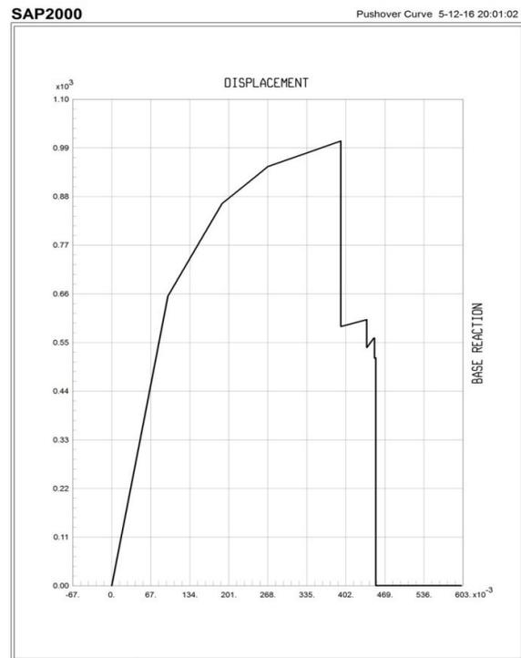
FIGURE5. PUSHOVER CURVE OF 5 STOREY FRAME
