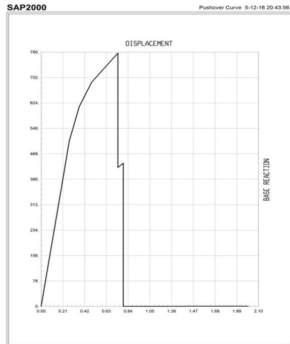
FIGURE6. PUSHOVER CURVE OF 13 STOREY FRAME
